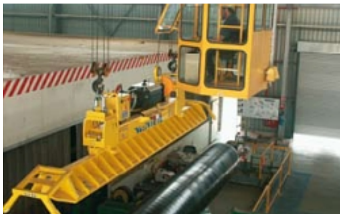
VACUVIETZ работа с краном (две подвески)
