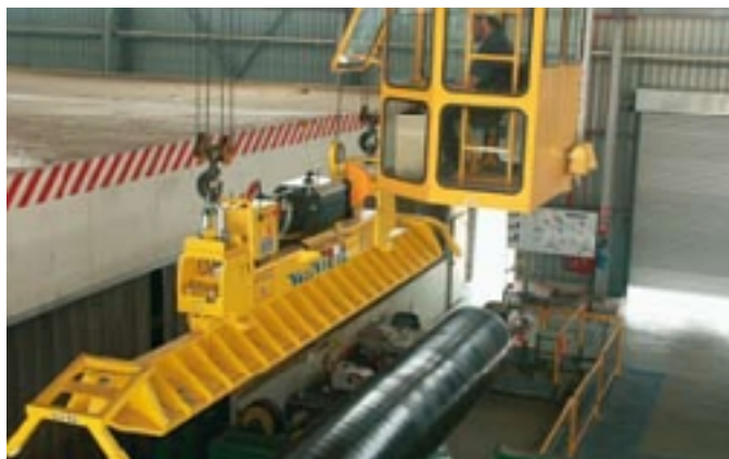
VACUVIETZ работа с краном (две подвески)
