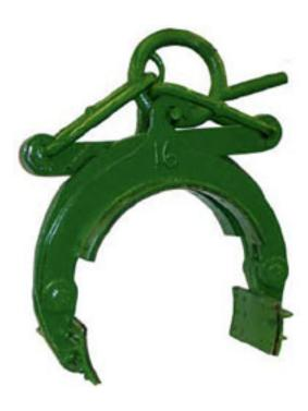
Захват «Pipe Tongs» применяются для надежной транспортировки труб в траншею или установки их на площадке. Захват имеет специальные прокладки из резины, что позволяет исключить порчу поверхности трубы. Используется для труб диаметром от 51 до 914 мм. На каждый диаметр трубы выпускается своя модель захвата. Захват «Pipe Tongs» позволяет поднимать трубы и фитинги из различных видов металла и нержавеющей стали весом от 900 до 4500 кг.
