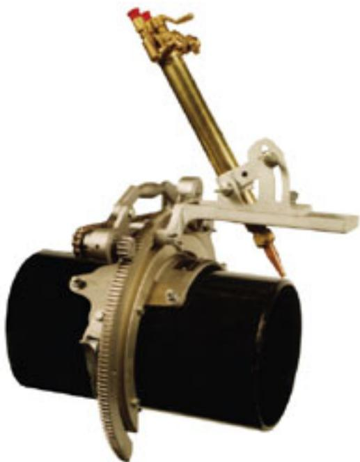
Ручная машина «Saddle Machine» была специально разработана для резки труб в тех случаях, когда необходимо сделать точный и качественный рез. Легкая, износоустойчивая машина известна на рынке более 60 лет как эталон долговечности, надежности и точности. Как опытный, так и начинающий сварщик может улучшить качество и точность своей работы. Применяется для резки труб диаметром 38–1220 мм.
