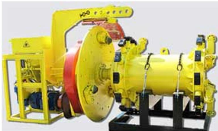
Станок предназначен для изменения геометрии кромок (снятие фасок) под сварку на трубах при строительстве магистральных трубопроводов в полевых и стационарных условиях.
