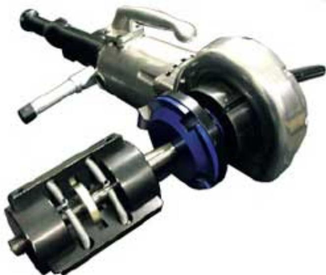
Устройство для нарезания фаски на трубах (кромкорез) «Porta-Mill End Prep Machine» выпускается компанией Mathey Dearman Inc. и предназначена для механической торцевой обработки кромки, снятия фаски и расточки края трубы. Является рабочим инструментом для электрических и пневматических резьбонарезных клуппов. Состоит из режущего, фиксирующего узлов и привода (в комплект не входит и заказывается отдельно).
