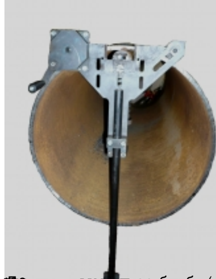
Устройство для снятия фаски на трубах (в комплекте)
