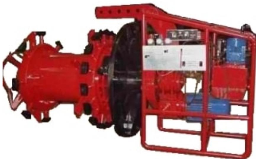
Машина подготовки кромок предназначена для обработки и зачистки торца и фасок под сварку на трубах для магистральных трубопроводов.
