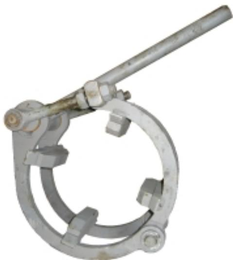
Предназначен для центрования торцев труб диаметрами 89 - 426 мм перед сваркой.
