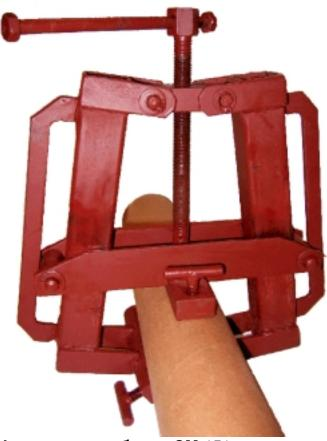
**Центратор-струбцина СМ** 151 предназначена для центровки торцов труб и отводов перед сваркой стыков диаметром от 57 до 159 мм при температуре окружающего воздуха от -40 до +40 град. С.
