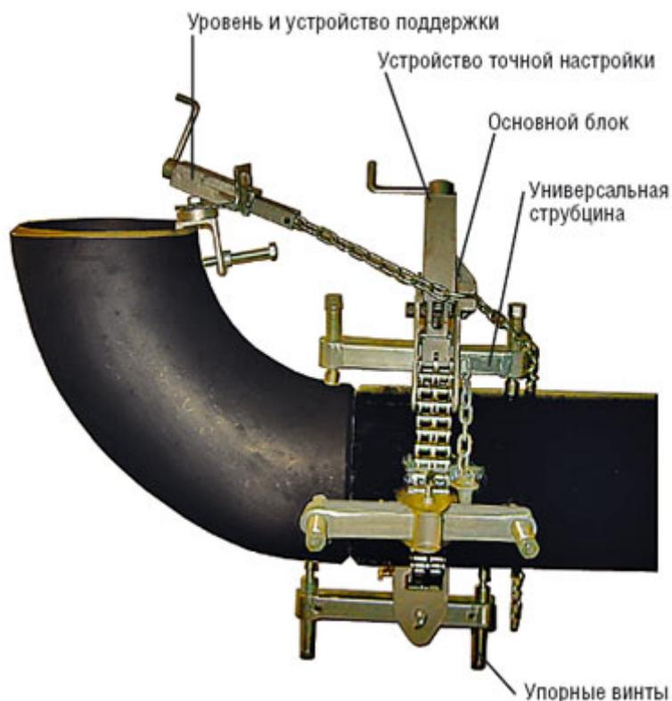
Универсальный центратор «Universal Chain Clamp» создан для того чтобы проварить 100% шва между трубами, без снятия центратора с трубы. Специальная «скользящая» конструкция струбцины позволяет ее сдвинуть, не снимая центратора. Соединяет и выравнивает трубы с толщиной стенки до 18 мм. . Существуют модели из углеродистой и нержавеющей стали для труб диаметром 25–1420 мм.
