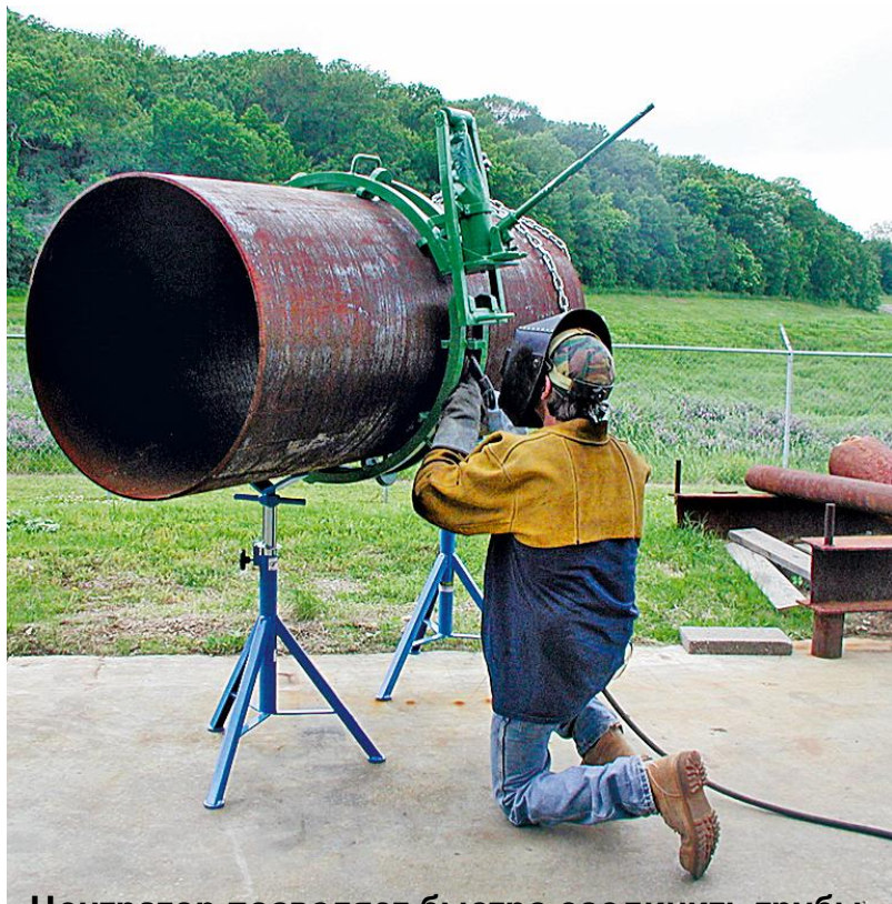
Центратор позволяет быстро соединить трубы
