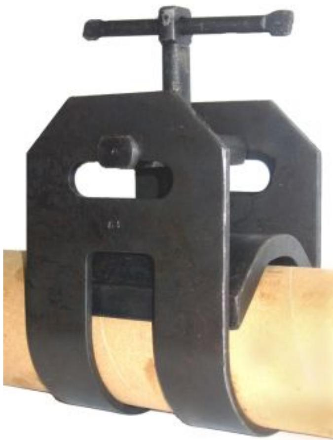
Центраторы для труб типа Ц (далее – центратор) предназначены для центрирования труб в стык под сварку при монтаже трубопроводов диаметром от 25 до 108 мм.
