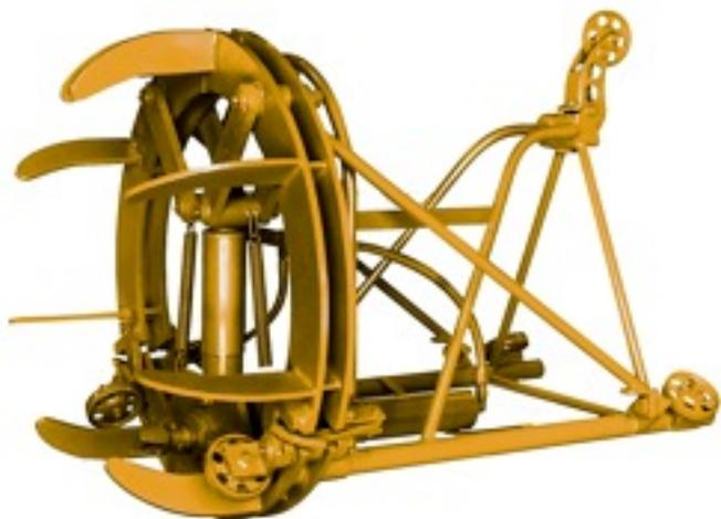
**Гидравлический внутренний центратор «Hydraulic Internal Alignment Clamp» (США)**
