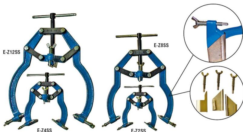
Модель центратора «EZ-Fit» создана для соединения под сварку труб, имеющих разные диаметры относительно друг друга и не требующих выправления окружности. Подходит для труб диаметром от 25 до 325 мм. Может быть использован для соединения нержавеющей труб под сварку, т.к. опоры имеют накладки из нержавеющей стали.
