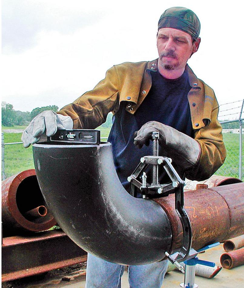
**Центратор может использоваться для закрепления труб и фитингов во время сварки. Посмотреть видео ролик работы центратора «E-Z Fit»**
