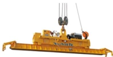
Механизм VACUVIETZ является инновационной разработкой фирмы VIETZ, специально рассчитанной на очень тяжелую работу на стройплощадках нефтегазопроводов, а также трубных заводах. Совершенно независимая от агрегата-носителя, работающая по вакуумному принципу трубоподъемная система предназначена для увеличения эффективности и безопасности строительства трубопроводов.
